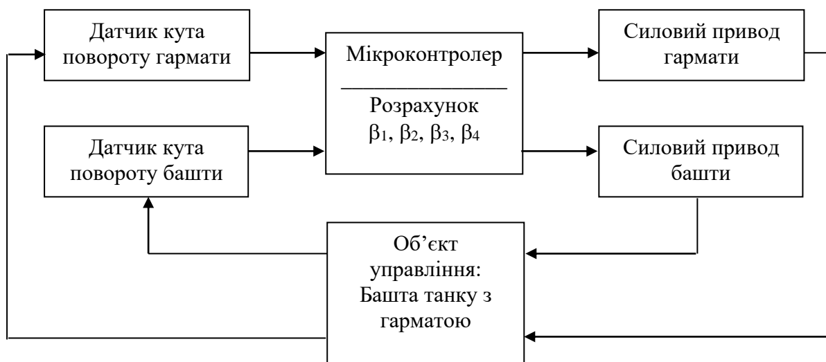
Рис. 2.29. Структурна схема апаратно-програмного рішення по реалізації нечіткої системи управління баштою танку.
